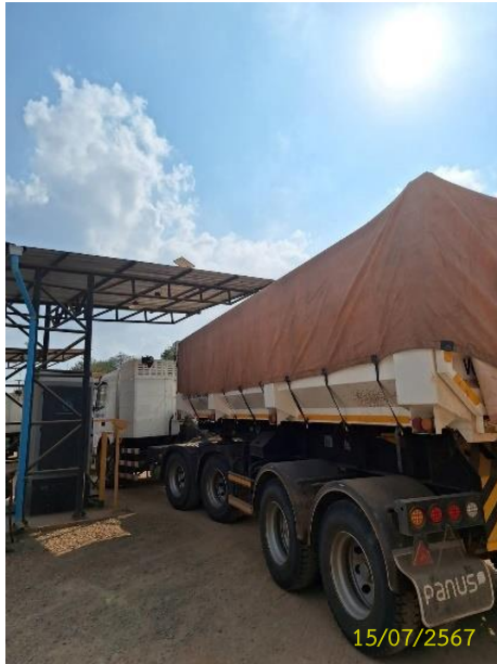
รูปที่ 8 การใช้ผ้าใบหรือพลาสติกคลุมวัสดุที่อาจมีการฟุ้งกระจายอย่างมิดชิดระหว่างการขนส่ง
